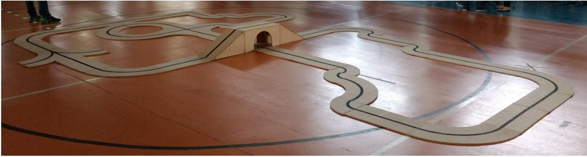
Poderá haver o desafio de determinação de distância na pista, sendo esse da seguinte forma: se tiver rampa na pista o autômato deverá parar embaixo da rampa, mas o ponto de parada deve ser determinada por um sensor de distância. Além de parar embaixo da rampa o carrinho deverá parar também ao lado de uma bandeirinha de PARE. O ato de parar o autômato por causa da contagem da distância ou bandeirinha faz com que o carrinho tenha que permanecer parado por 5 segundos.
